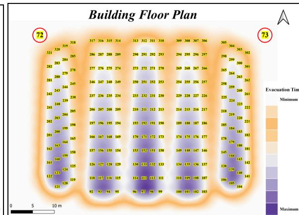
Figure 6.2. Building floor plan with maximum and minimum time through (a) door 70-72 (b) door 70-73 (c) door 70-71 (d) door 71-72 (e) door 71-73 and (f) door 72-73
